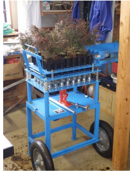
写真 24 コンテナ苗専用の抜き取り機
