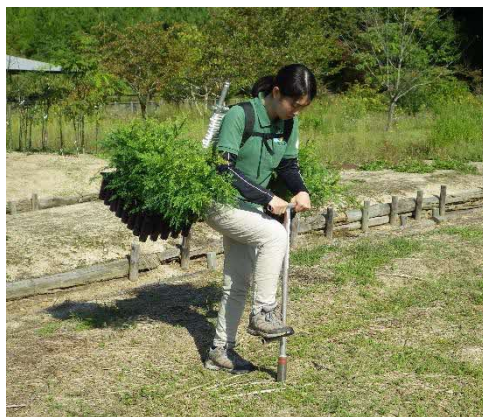
写真 30 コンテナごと苗の運搬と植栽を同時に行える背負子（島根県中山間地域研究センター試作）
