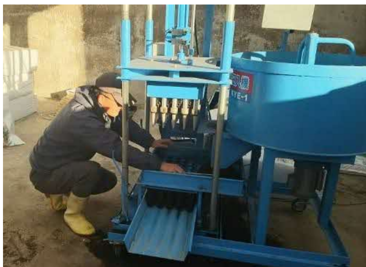
写真7 コンテナ苗用培土圧注機
