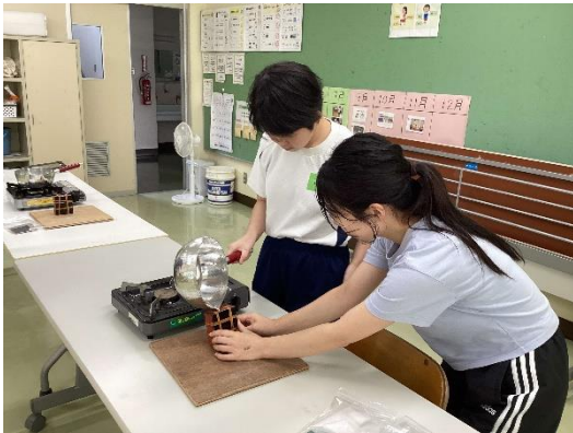
溶かした金属をそっと鋳型に流し込みます
