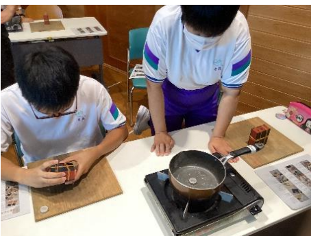
金属鏡の鑄型を輪ゴムでしっかりと固定しておき、低融点金属素材を熱して溶かす
