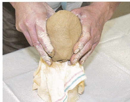
①型に湿った布を巻き、その上から粘土を押しつける。
