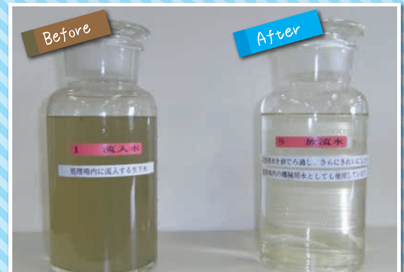
下水処理場に入ってくる水 (一般家庭等から出てくる水) / 下水処理場から出て行く水 (微生物のちからでキレイになった水)
