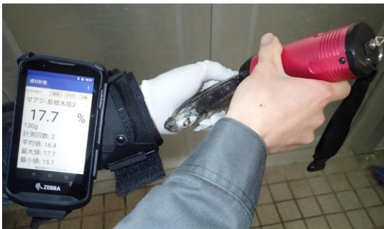
魚の「脂の乗り」が測定できる脂質測定器の開発
